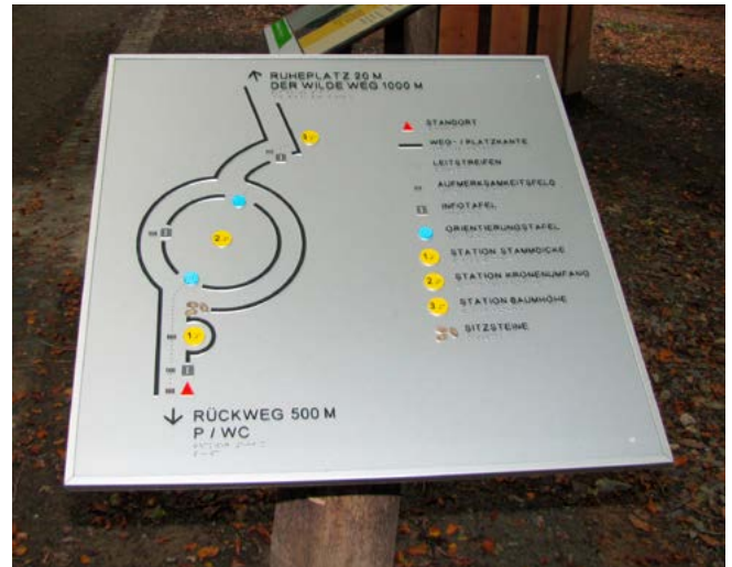
Abbildung 19: Taktile Übersichtskarte für ein Wegeteilstück mit Platzsituation am barrierefreien Wanderweg „Wilder Kermeter“ im Nationalpark Eifel. (Quelle: Nationalparkverwaltung Eifel)
